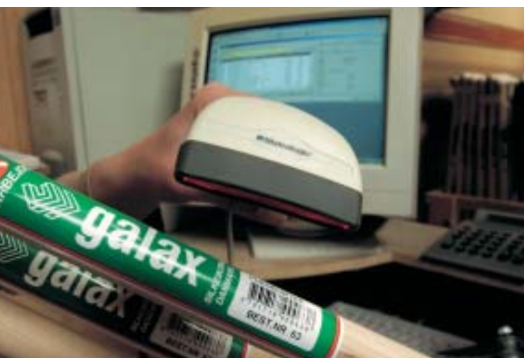
Fra montageafdelingen scannes varen ind på lageret med en simpel, billig læser. Varelageret ajourføres og samtidig kontrolleres, at strekkoden er læsbar.
